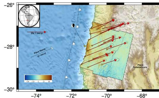
Figura 1: Representación de la velocidad en el LOS (line of sight) de InSAR en conjunto con los datos GNSS en el LOS (círculos). Además, se grafica en conjunto con los datos GNSS obtenidos del modelo trayectoria (flechas). Los valores positivos significan desplazamiento hacia el satélite.
